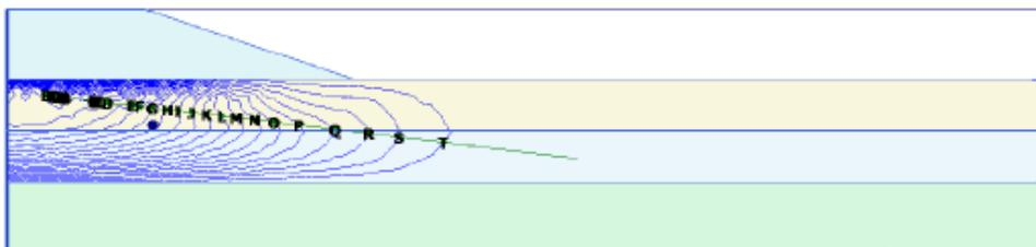
图 4.5 固结到  $P_{excess} < 1.0 \text{ kN/m}^2$  后的超孔隙水压等值线
